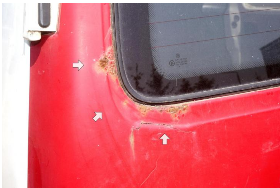
Fot. 24. korozja drzwi lewych
