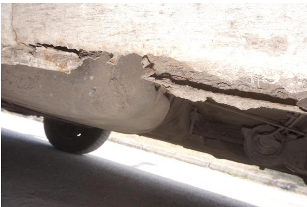
Fot. 27. korozja progów, ubytki materiałowe
