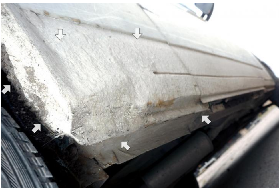
Fot. 29. łaty naprawcze ścian bocznych i progów
