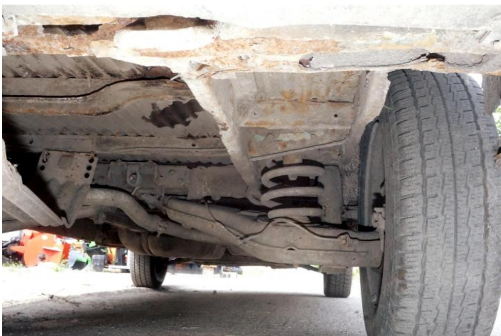
Fot. 26. intensywna korozja
