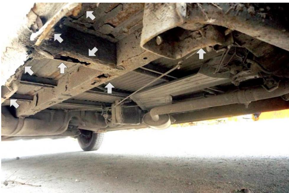
Fot. 28. ubytki korozyjne szkieletu podłogi
