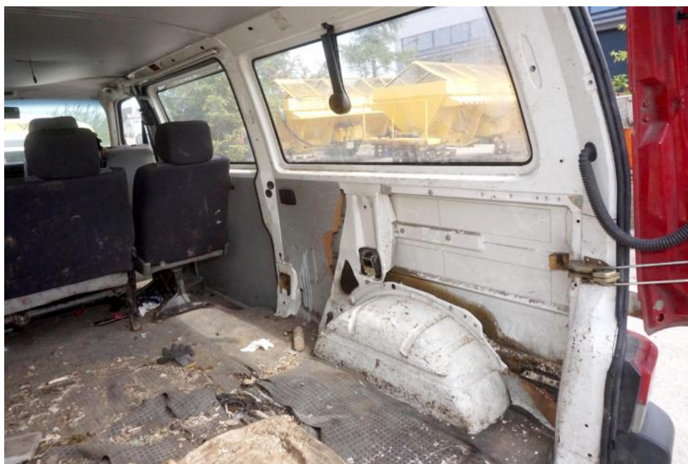
Fot. 21. zniszczenia osprzętu części ładunkowej
