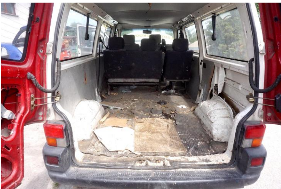
Fot. 20. zniszczenia przedziału ładunkowego
