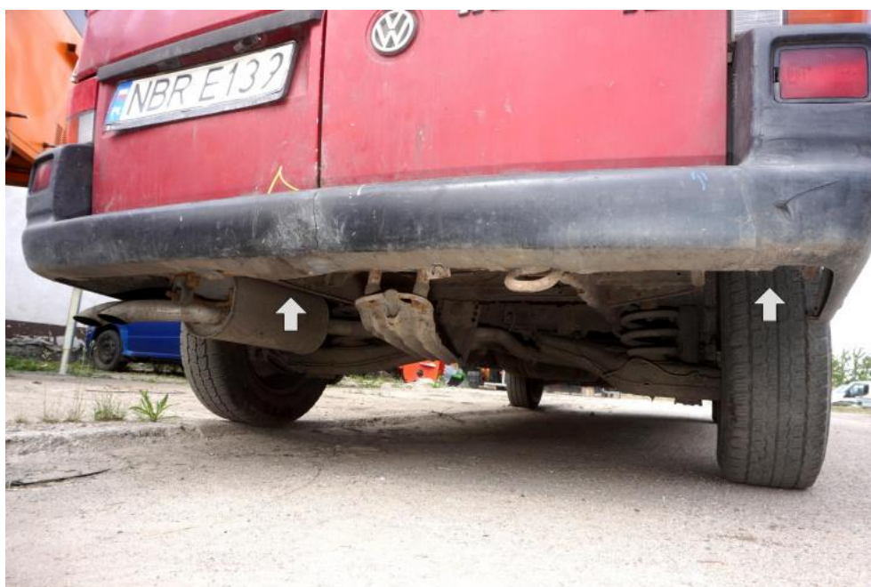
Fot. 23. uszkodzenia zderzaka tylnego
