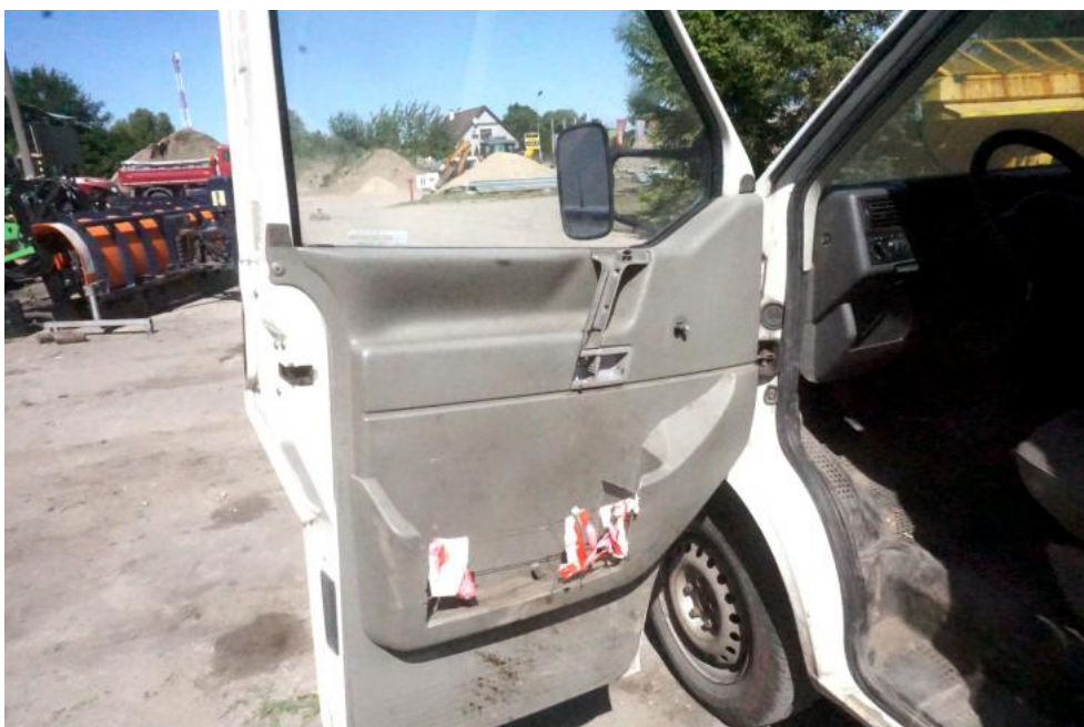
Fot. 14. uszkodzenia osprzętu drzwi
