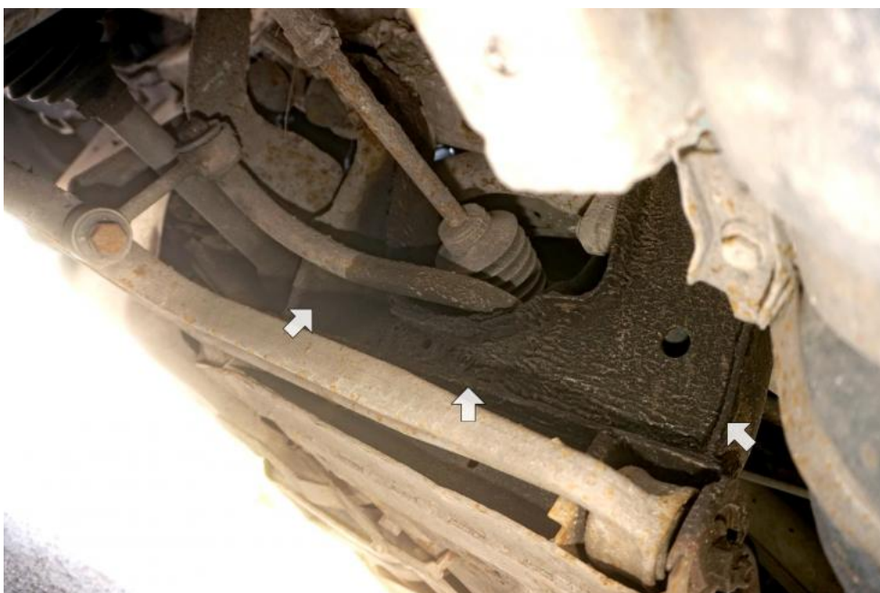
Fot. 30. wycieki olejowe
