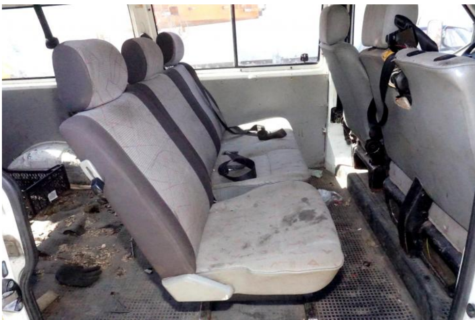
Fot. 19. zniszczona tapicerka siedzeń środkowych
