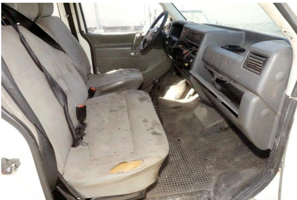
Fot. 18. zniszczona tapicerka przednich siedzeń
