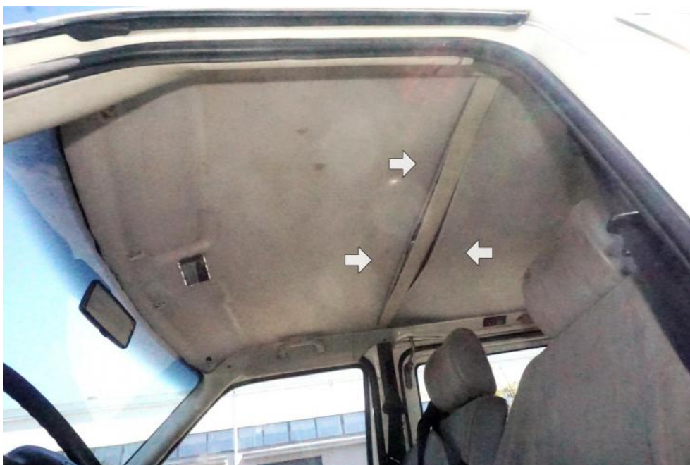
Fot. 15. opuszczona podsufitka
